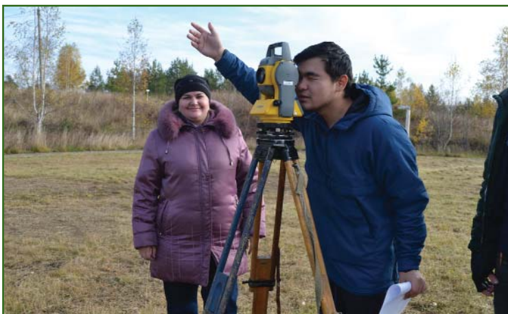
Рис. 1 Вынос в натуре точек по известным координатам
